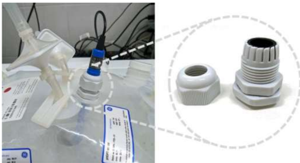
Rysunek 3. Sposób mocowania elektrody pH do polimerowego zbiornika Cellbag™ 2 L przy zastosowaniu dławnicy kablowej (na podstawie: materiały uzupełniające do artykułu [A1]).
