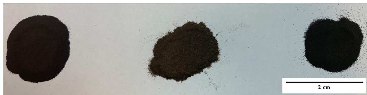
Rysunek 31 Przesiane modyfikowane napelniacze; od lewej: WA-g-OLA; SP-g-OLA; WB-g-OLA
