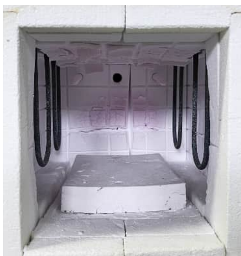
Rys. 31. Komora pieca po wygrzewaniu próbek z układu \text{Al}_2\text{O}_3\text{-Cu-Cr}
