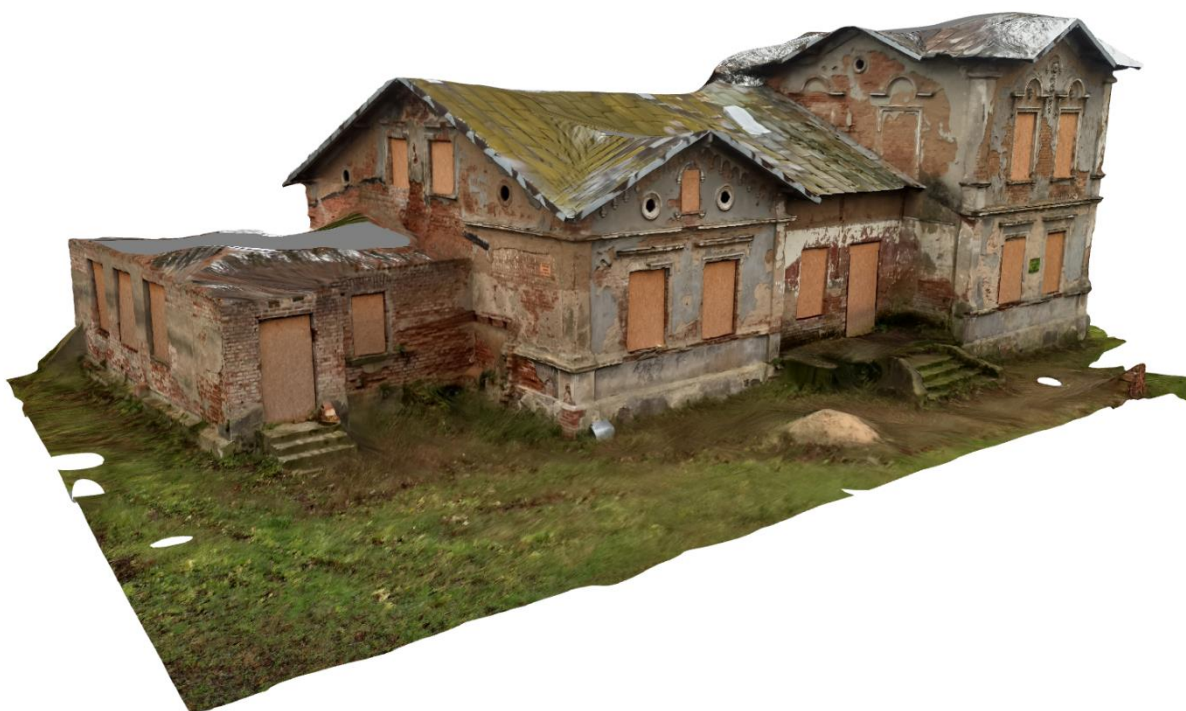
Rysunek 67 Model dworu w Kliczewie Małym stworzony w programie ReCap Photo po usunięciu otoczenia oraz docięciu przyziemia.
