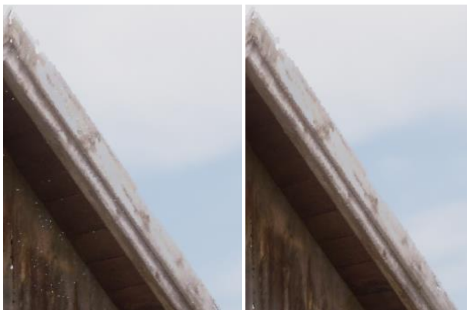
Rysunek 51 Porównanie fragmentu ujęcia chmury punktów z różnymi wielkościami punktów. Po lewej wielkość punktów z wartością 1.0, po prawej z wartością 1.4.
