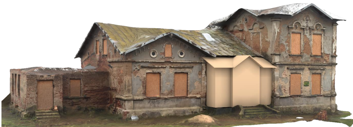
Rysunek 91 Wizualizacja stworzona w programie 3DS Max z wykorzystaniem silnika renderującego Corona obejmująca model MESH stworzony na podstawie SfM z uproszczonym modelem ganku.
