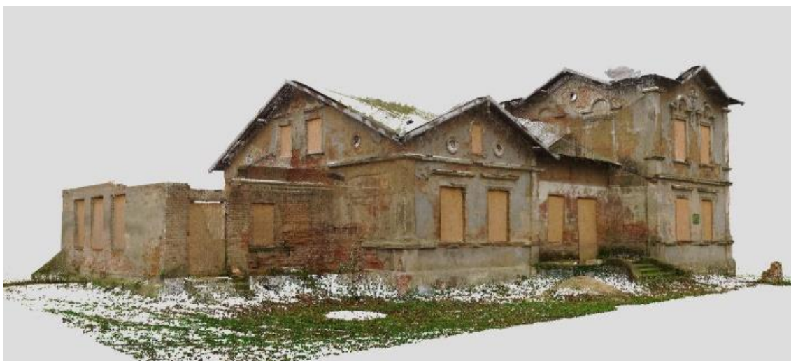
Rysunek 85 Chmura punktów dworu w Kliczewie Małym opracowanego na podstawie skanu laserowego na platformie Sketchfab.
