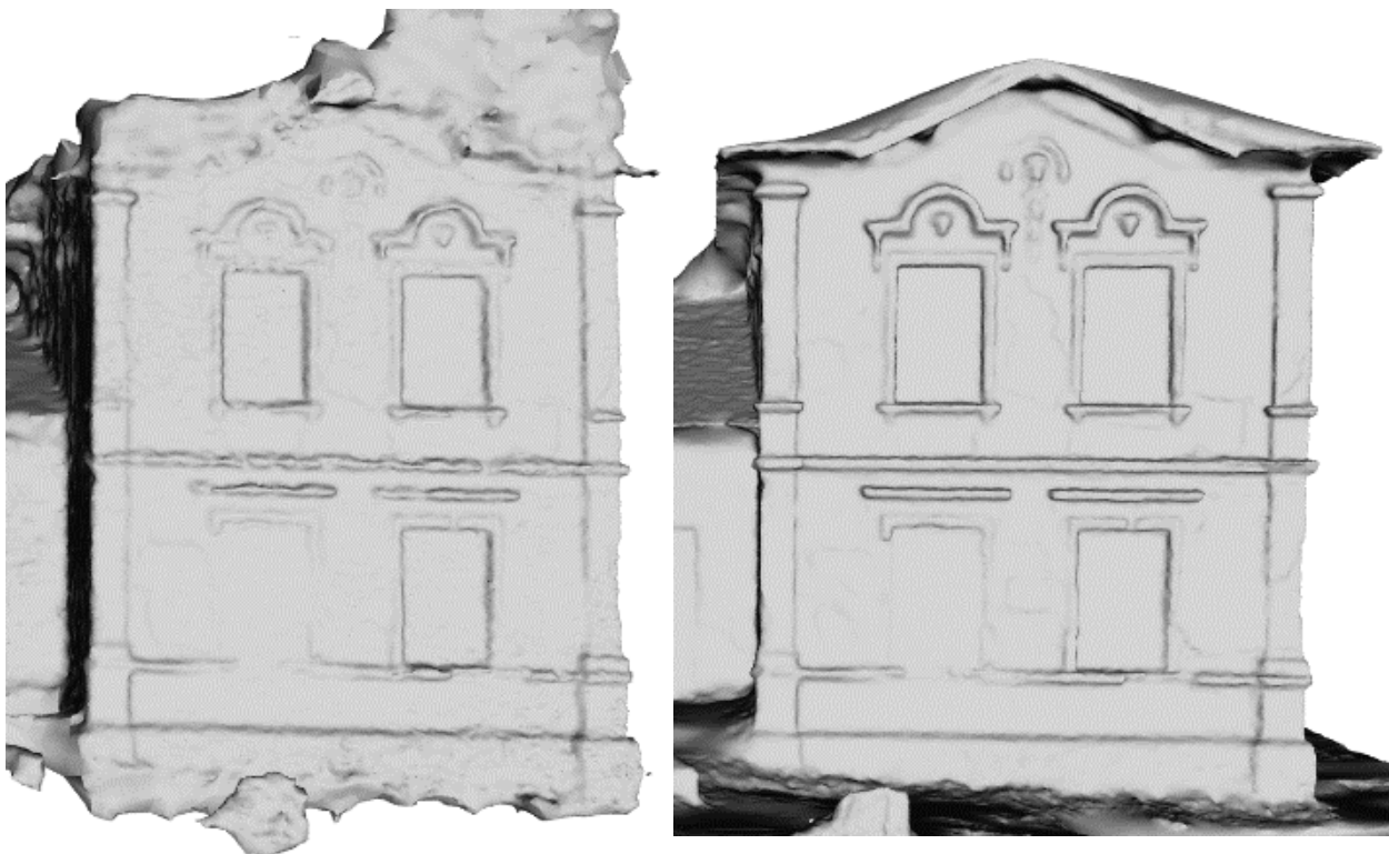
Rysunek 72 Widok fragmentu modeli w trybie "Solid" w programie ReCap Photo. Lewy model stworzony w programie Meshroom, prawy w programie ReCap Photo.
