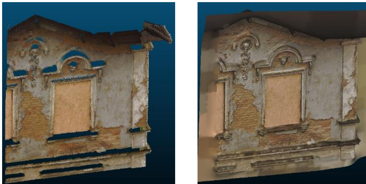
Rysunek 87 Po lewej fragment chmury punktów dworu w Kliczewie Małym. Po prawej: geometria mesh stworzona na podstawie chmury punktów w programie CloudCompare.
