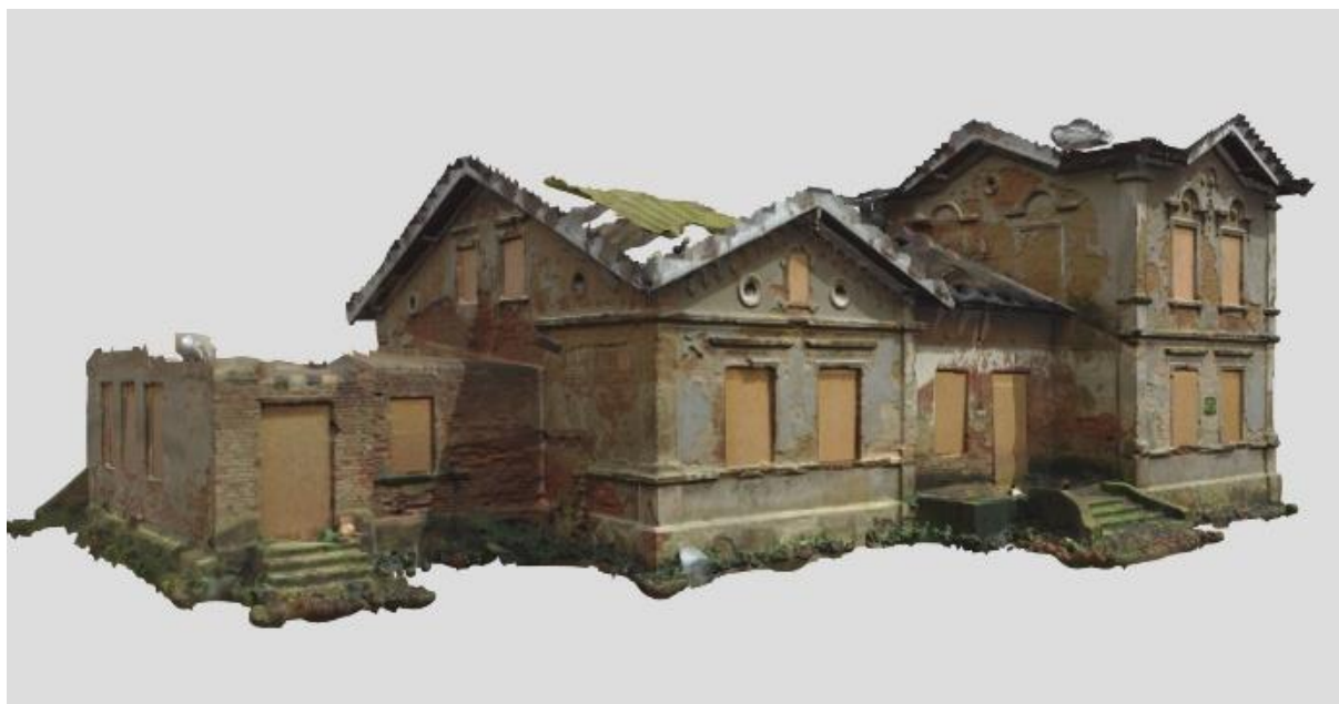
Rysunek 83 Model mesh dworu w Kliczewie Małym na platformie Sketchfab opracowany na podstawie chmury punktów.
