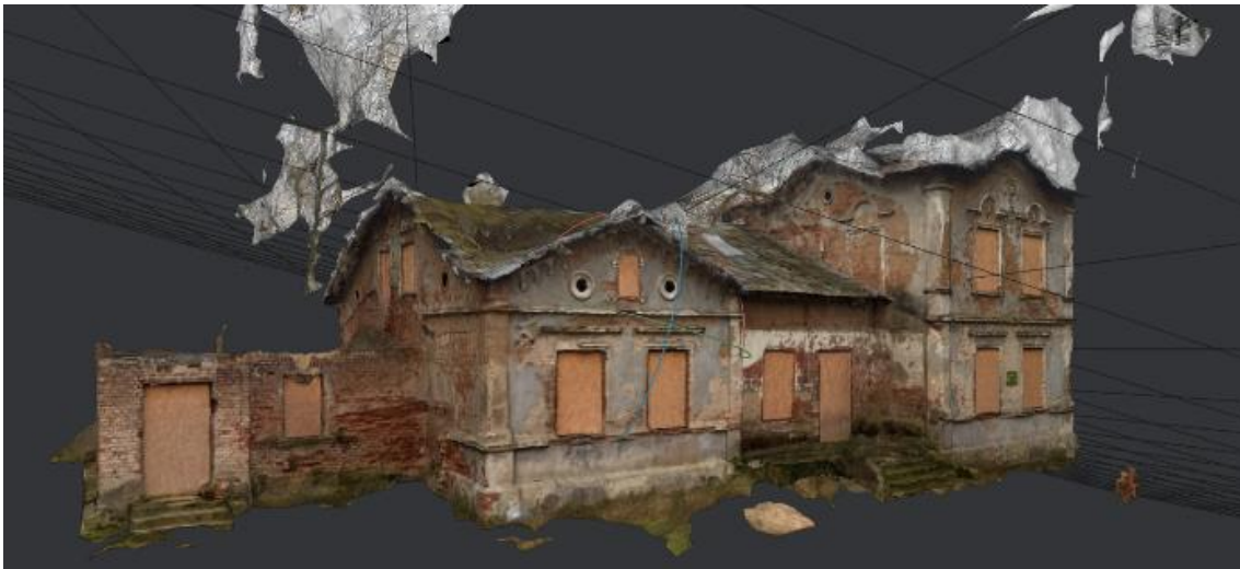
Rysunek 69 Model 3D dworu w Kliczvie Małym stworzony w programie Meshroom po wykonaniu zadań " Meshing " i " Texturing ".
