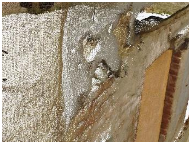
Rysunek 8 Przykład widoku fragmentu chmury punktów dworu w Kliczewie Małym wykonany w programie ReCap. Zbliżenie na pojedyncze punkty tworzące chmurę punktów.
