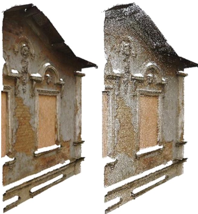
Rysunek 9 Różna gęstość chmury punktów fragmentu elewacji dworu w Kliczewie Małym przedstawiona w programie ReCap. Lewy rysunek: gęstość z parametrem „ decimation grid ” o wartości 1 mm. Prawy rysunek: gęstość z parametrem „ decimation grid ” o wartości 50 mm.
