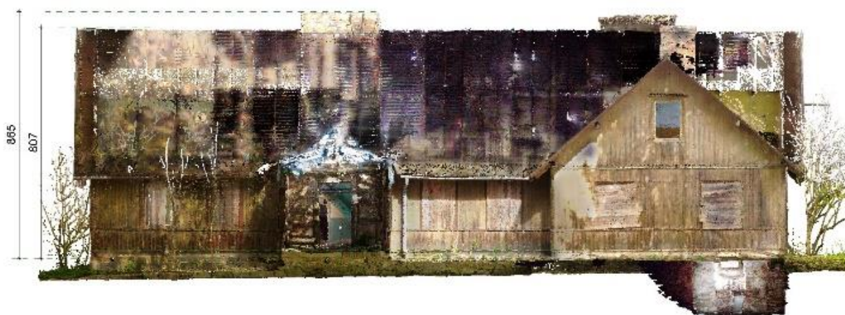
Rysunek 44 Widok elewacji dworu w Nużewie na podstawie chmury punktów z oznaczoną wysokością.
