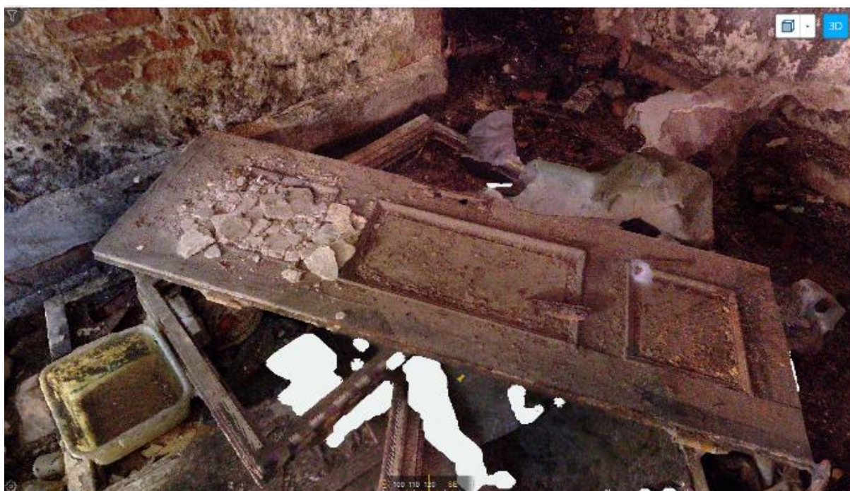
Rysunek 54 Widok fragmentu chmury punktów przedstawiający skrzydło stolarki drzwiowej w przeglądarce Faro WebShare.
