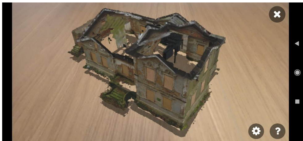
Rysunek 82 Widok na telefonie komórkowym z użyciem aplikacji Sketchfab prezentujący użycie rozszerzonej rzeczywistości. Widoczny model mesh dworu w Kliczewie Małym, opracowany na podstawie chmury punktów otrzymanej przez skanowanie laserowe.
