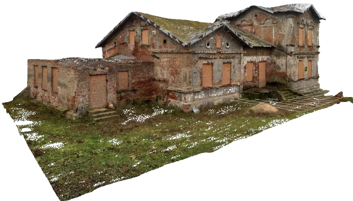
Rysunek 74 Chmura punktów dworu w Kliczewie Małym będąca eksportem modelu mesh stworzonego przy użyciu techniki SfM do formatu .pts.
