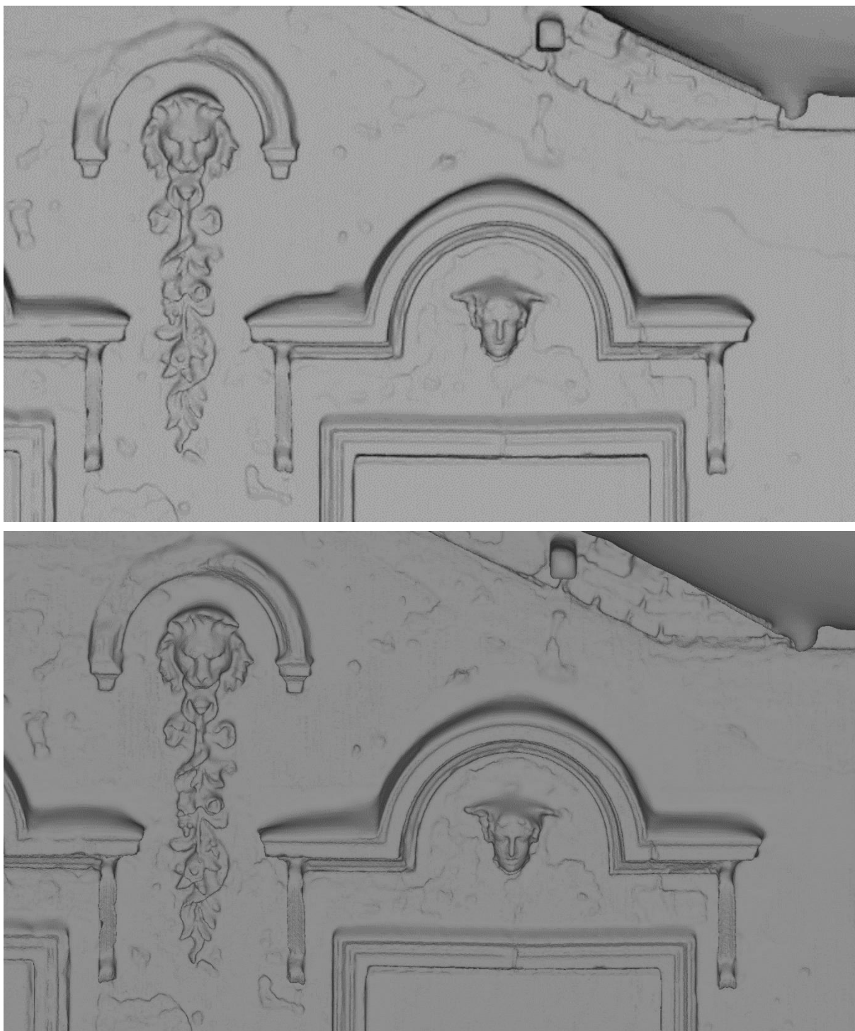
Rysunek 88 Modele mesh fragmentu elewacji dworu w Kliczewie Mały stworzone na podstawie chmury punktów. Górny obraz: model stworzony w programie CloudCompare, dolny obraz: model stworzony w programie MeshLab. Dla obu procesów konwersji zastosowano odpowiadające parametry szczegółowości.
