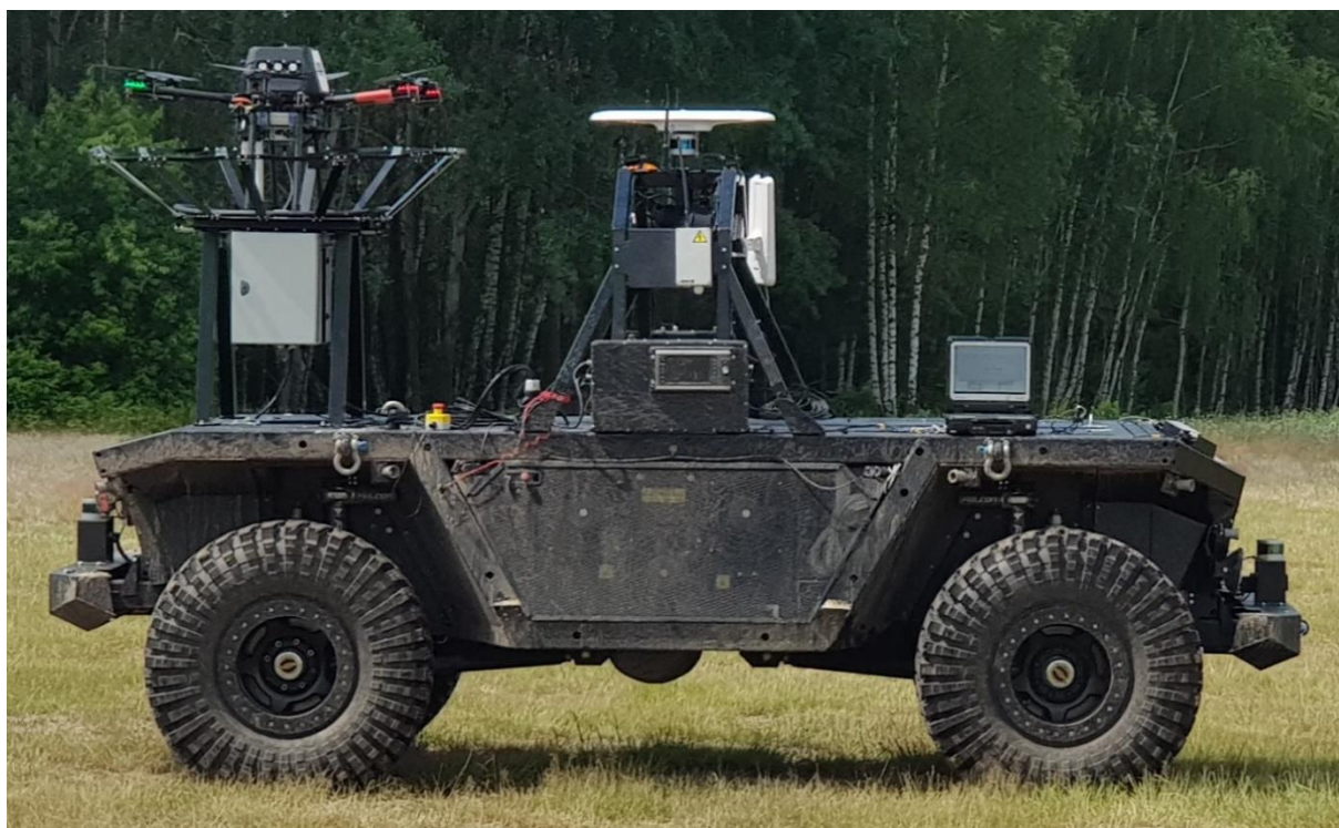
Rysunek 13. Wynik projektu „Opracowanie wysoko mobilnej bezzałogowej platformy hybrydowej do zadań szybkiego reagowania” – BPL HUNTeR wraz z dronem na uwięzi. [materiały własne doktoranta]
