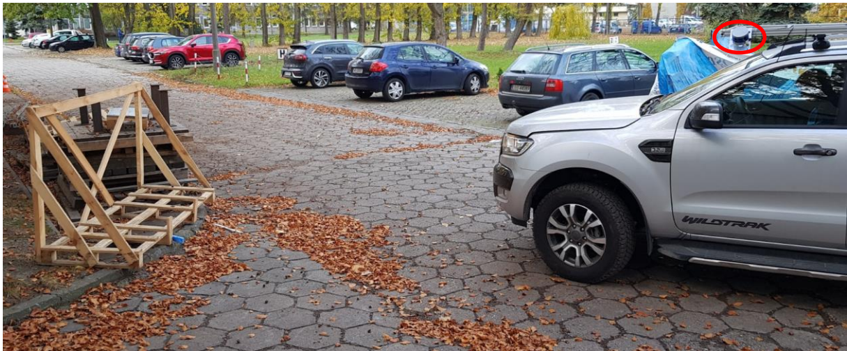
Rysunek 45 Miejsce testów - przeszkoda z krzyżem, ustawienie lidar – na dachu od strony kierowcy, warstwy pod kątem 45°.
