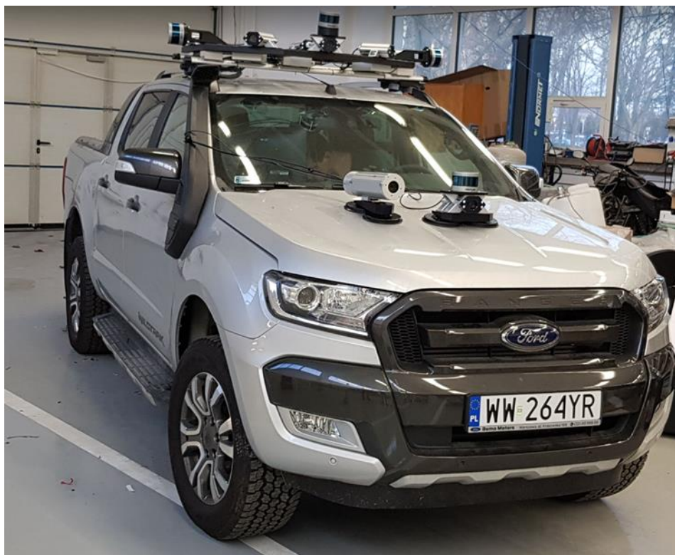
Rysunek 72. Demonstrator PIAP ATENA podczas zbierania danych o otoczeniu z wykorzystaniem kamery hiperspektralnej Cubert Q285 na Poligonie w WITU. Poniżej przygotowania do testów, na zdjęciu widać miejsce montażu kamery hiperspektralnej.
