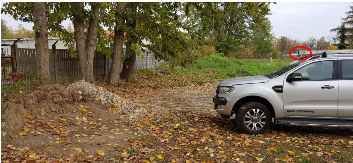
Rysunek 43 Miejsce testu-nasyp z ziemi i kamieni, ustawienie lidar – na dachu od strony kierowcy, warstwy pionowe.
