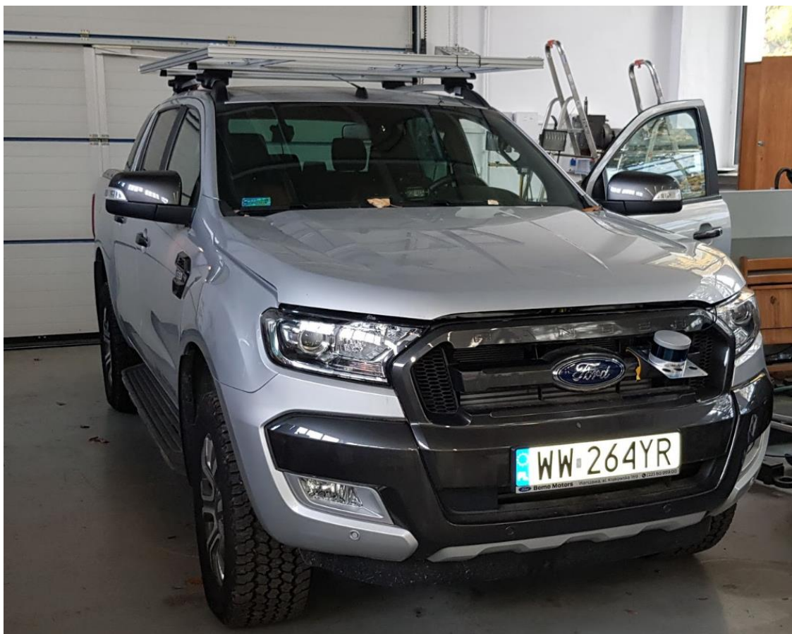
Rysunek 38. Prototypowy stelaż na czujniki i element montażowy w okolicy grilla.
