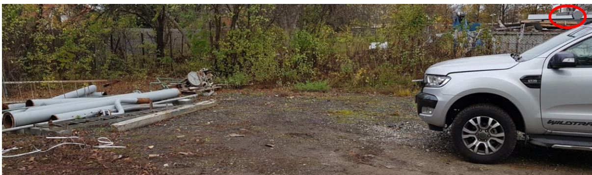
Rysunek 41 Miejsce testów-rury przy drzewach, ustawienie lidar – na dachu od strony kierowcy, warstwy pionowe.
