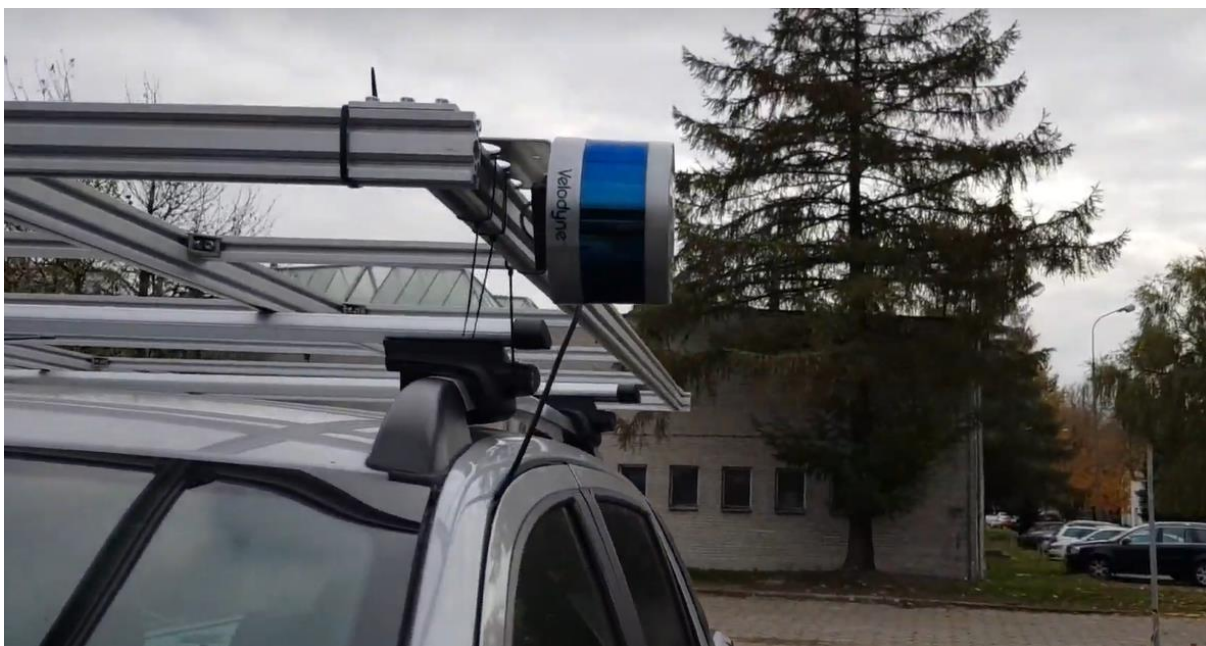
Rysunek 3. LiDAR Velodyne VLP-16 podczas testów różnego rozmieszczenia sensora na pojeździe PIAP ATENA.
