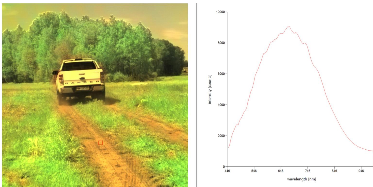
Rysunek 24. Po lewej obraz z kamery hiperspektralnej Cubert Q285, po prawej wykres przebiegu hiperspektralnego dla jednego piksela zaznaczonego na czerwono na rysunku po lewej.
