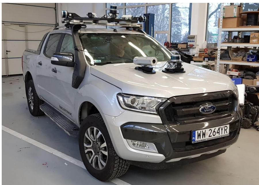
Rysunek 34. Demonstrator technologii PIAP ATENA z kamerą hiperspektralną zamontowaną na masce pojazdu.
