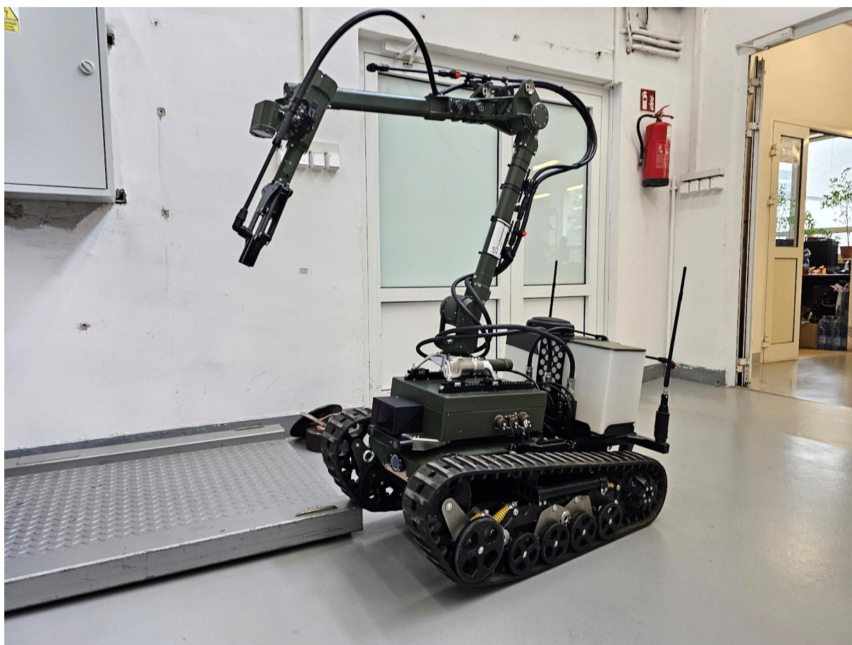
Rysunek 12. Główny wynik projektu DEZROB: Prototyp Robota PIAP PATROL w wersji DEZROB z systemem oprysku i modulem autonomii. [materiały własne doktoranta]
