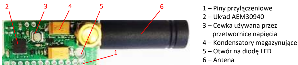
Rysunek 4.5. Moduł odpowiadający za zasilanie bezprzewodowe
