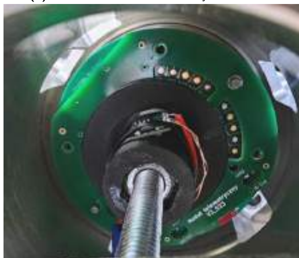
(c) Wspornik cewki zasilającej przy module
