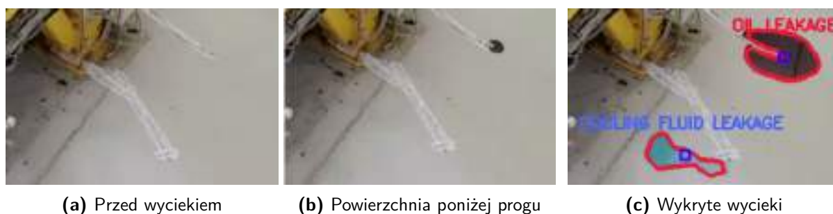
Rysunek 4.73. Symulacja wycieku oleju i glikolu
