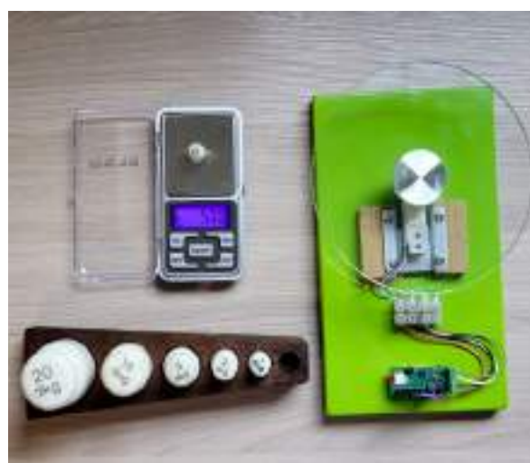
(b) Test wykorzystaniem precyzyjnej wagi
