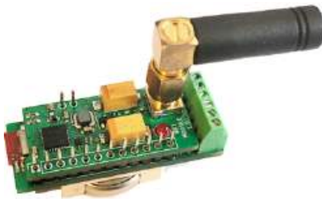
Rysunek 4.6. Przetwornik z zainstalowanym modułem zasilającym (przed zlutowaniem)
