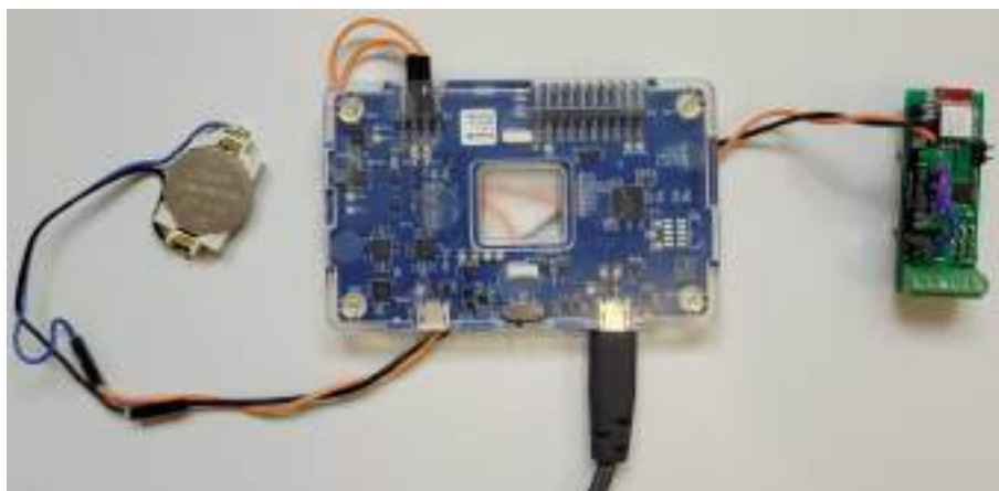
Rysunek 4.20. Stanowisko do testów zużycia energii
