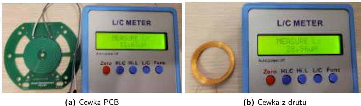
Rysunek 4.37. Pomiar indukcyjności cewek
