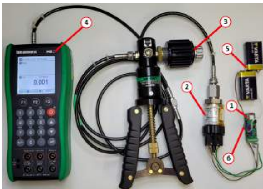
Rysunek 4.19. Test obsługi czujnika ciśnienia z wyjściem napięciowym
