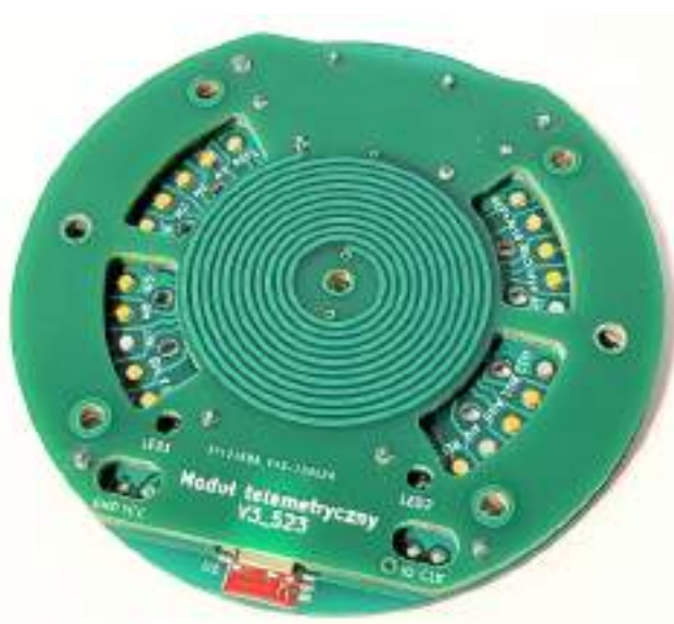
Rysunek 4.40. Zmontowany moduł telemetryczny - prototyp III
