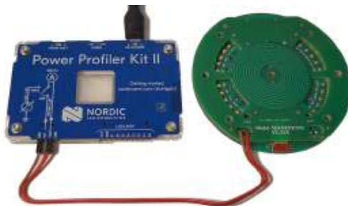
Rysunek 4.43. Badanie poboru prądu przetwornika obrotowego
