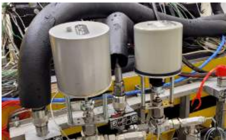
Rysunek 4.52. Ustawniki pozycyjne typu HH500 stosowane w Laboratorium Badania Łożysk
