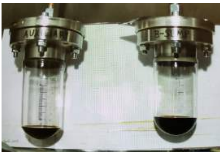
Rysunek 4.80. Zbiorniki w końcowej części instalacji służącej do pomiaru wycieku oleju
