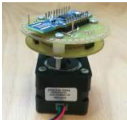
Rysunek 4.29. Układ do wstępnych testów komunikacji radiowej przy obracającym się module BLE
