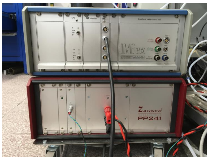
Rys. 32 Elektrochemiczna stacja pomiarowa Zahner Im6ex + PP241
