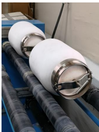
Rys. 36 Młyny kulowe do preparatyki proszków ceramicznych umieszczone na rolkach napędowych
