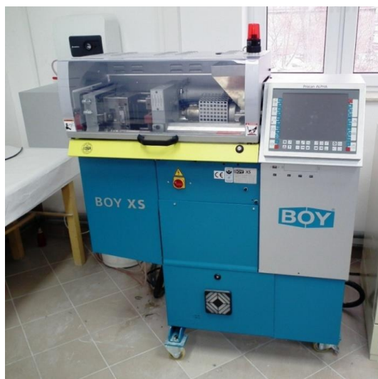
Rys. 38 Wtryskarka wysokociśnieniowa użyta do formowania substratów podłoży ogniów SOE
