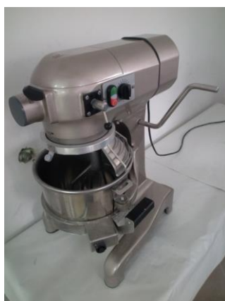
Rys. 37 Mieszalnik z mimośrodowym obrotowym mieszadłem do ujednolodniania masy
