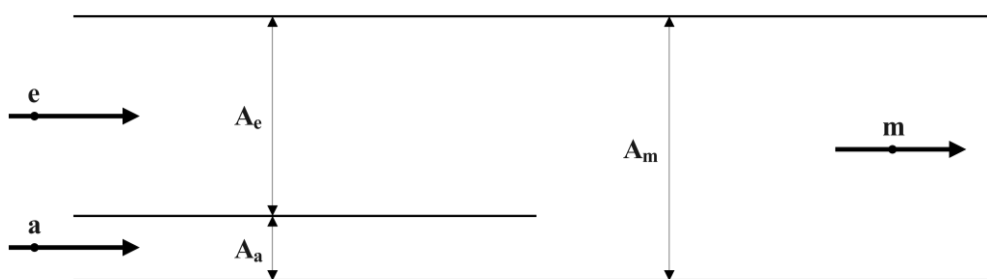
Rysunek 5.23: Schemat procesu mieszania gazów spalinowych i czynnika chłodzącego.
