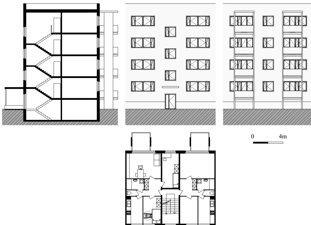
Rys. 6.4. Analizowany w pracy badawczej najpopularniejszy schemat centralnej klatki schodowej z mieszkaniami o układzie M2 i M3. Przekrój, elewacja frontowa i tylna oraz rzut powtarzalnej kondygnacji. Źródło: opracowanie własne na podstawie wizji lokalnej
