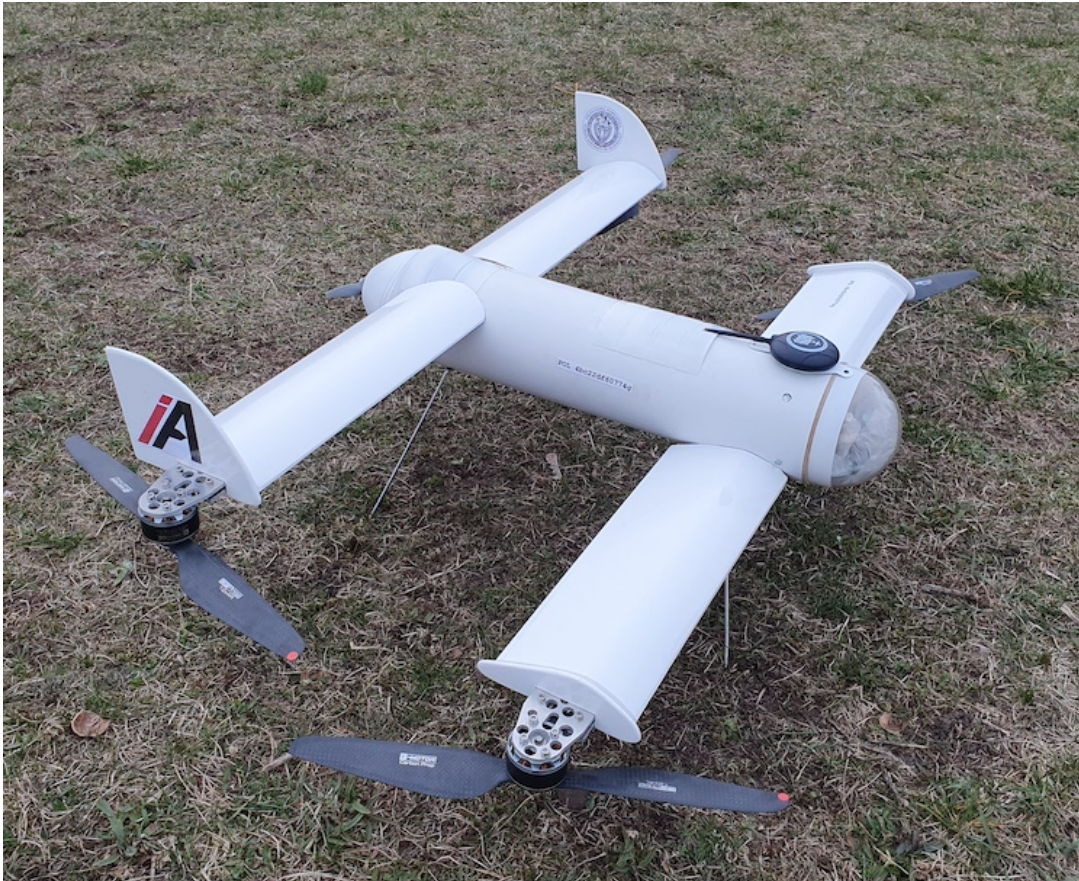
Rysunek 4.1: Elka1Q — dron typu „Tandem-Wing Quadplane”; zaprojektowany, zbudowany i przetestowany w toku studiów doktoranckich
