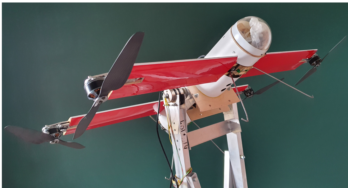
Rysunek 6.2: Bezpieczne środowisko testowe dla drona Elka1Q — uchwyt pozwalający na przechyły jedynie wokół osi Pitch
