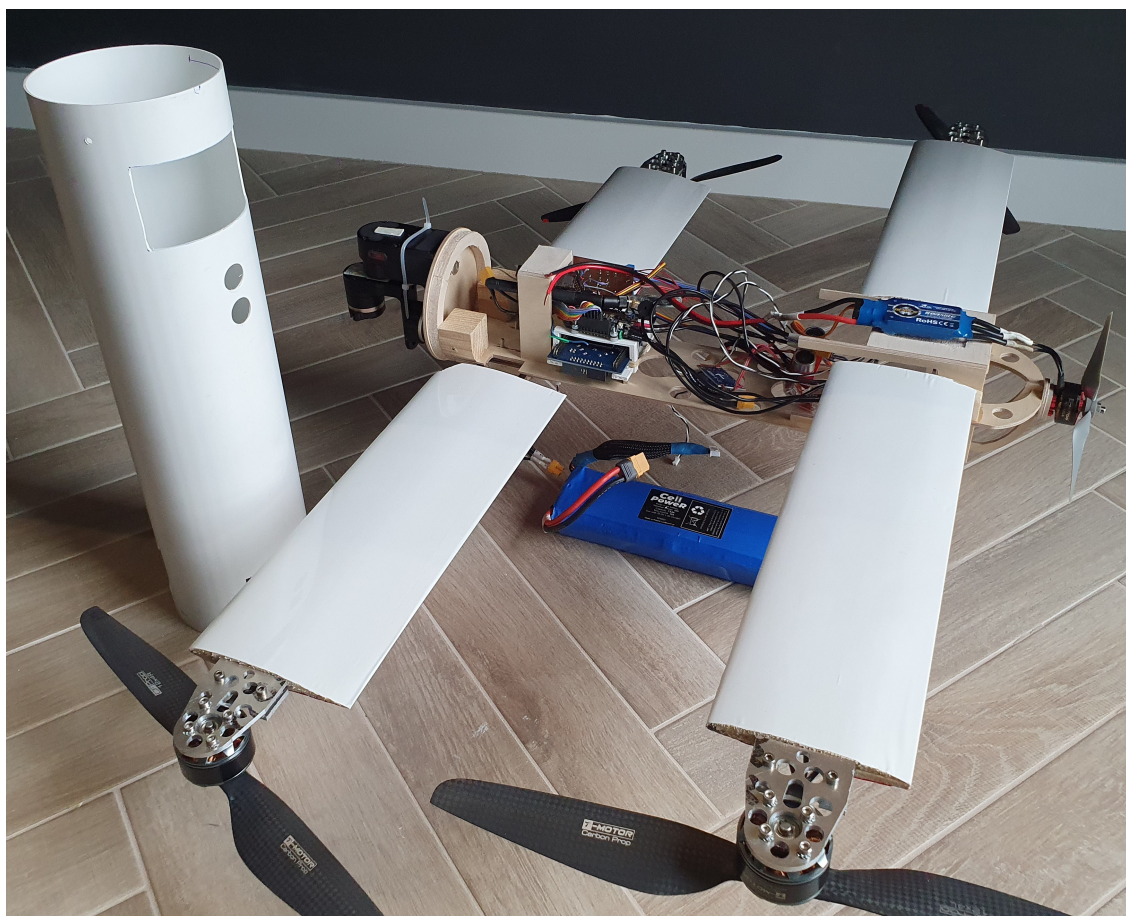
Rysunek 4.7: Dron Elka1Q — widoczna wewnętrzna struktura konstrukcji oraz skłupa kadłuba
