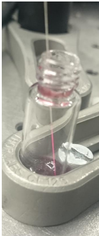
Rys. 22. Wypełnianie światłowodu fonicznego przygotowanymi mieszaninami z oświetlonym wypełnionym odcinkiem
