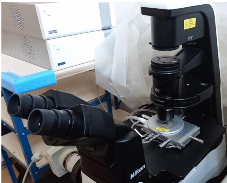
Rys. 29. Zdjęcie układu mikroskopu polaryzacyjnego ze stolikiem grzewczym
