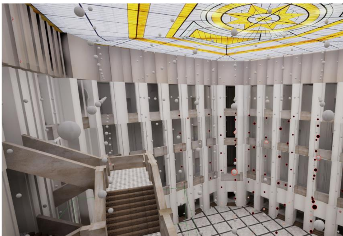
Rysunek 6.12. Wizualizacja technologii RTXGI pozwalającej na generowanie globalnego oświetlenia w oparciu o regularnie rozmieszczone próbki (opracowanie własne)
