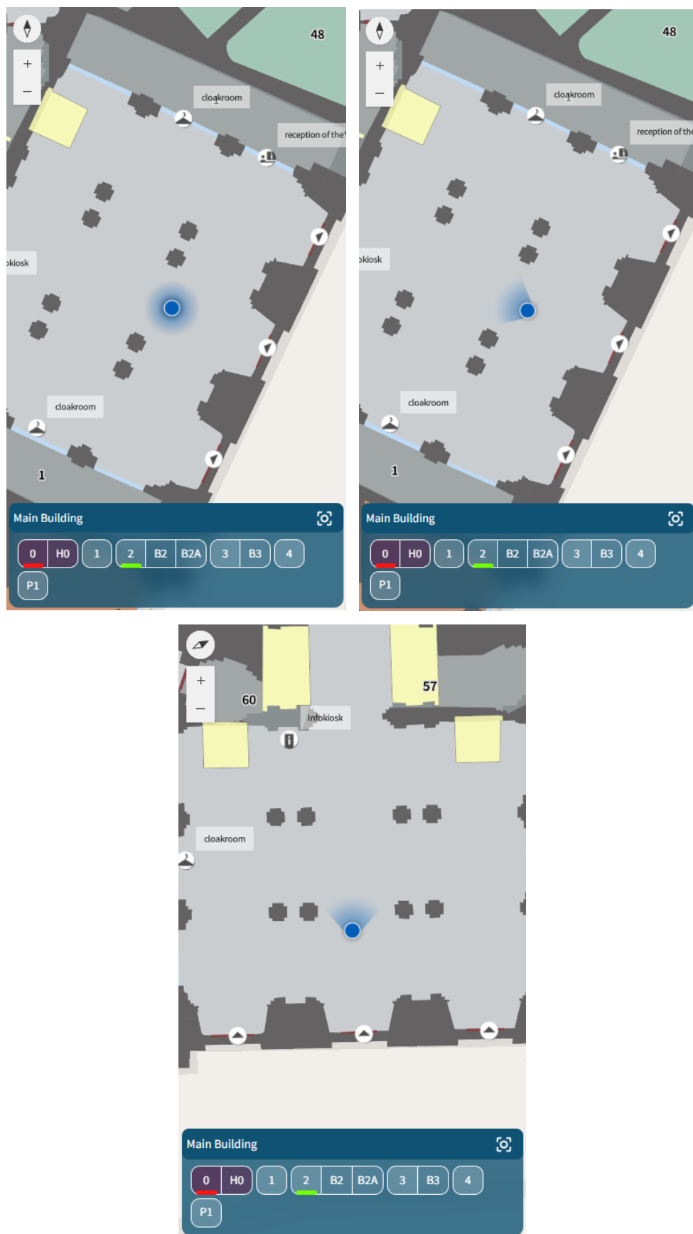
Rysunek 7.31. Ilustracja trzech trybów prezentacji rotacji określanych od lewej jako: Brak rotacji, Rotacja niebieskiej kropki, Rotacja mapy (opracowanie własne)
