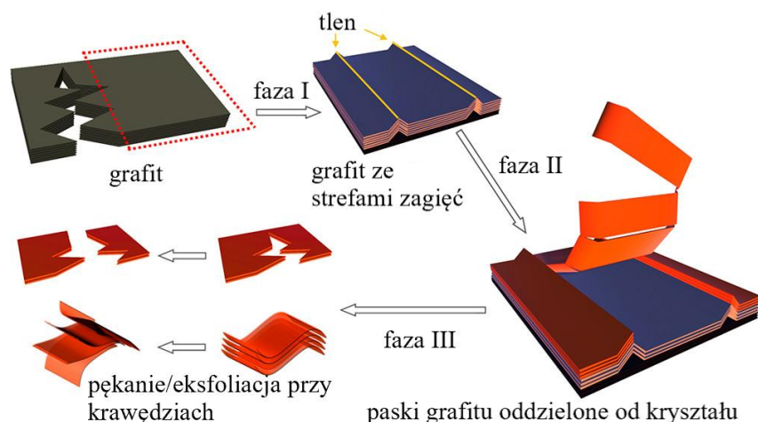
Rys. 2.4 Trzy fazy fragmentacji oraz eksfoliacji podczas metody mokrej eksfoliacji nanomateriałów na przykładzie grafitu: faza I obejmująca pękanie płatków i tworzenie pasm załamań/zgięć, faza II obejmuje oddzielanie cienkich pasków grafitu oraz faza III obejmująca eksfoliację do cienkich płatków. Obraz zaadaptowany z publikacji 61 .
