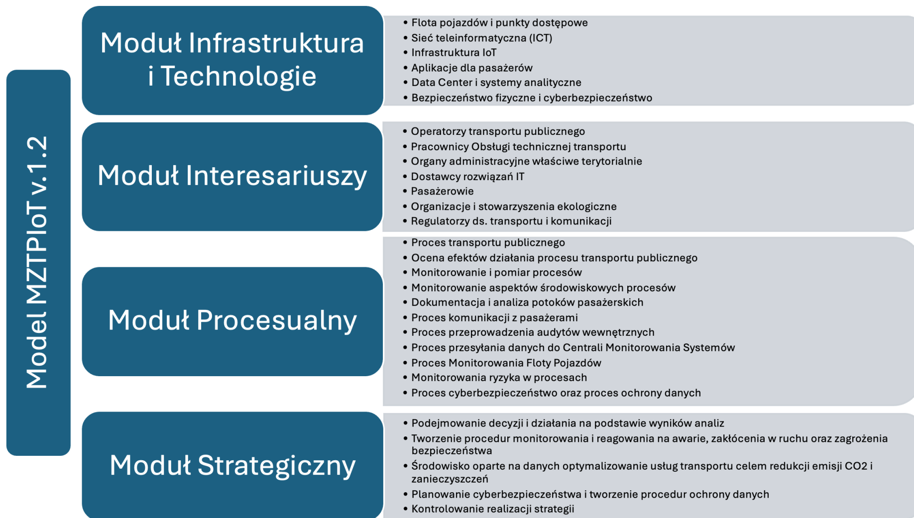
Rysunek 26. Moduły modelu MZTPIoT v.1.2 z wyszczególnionymi komponentami Źródło: opracowanie własne
