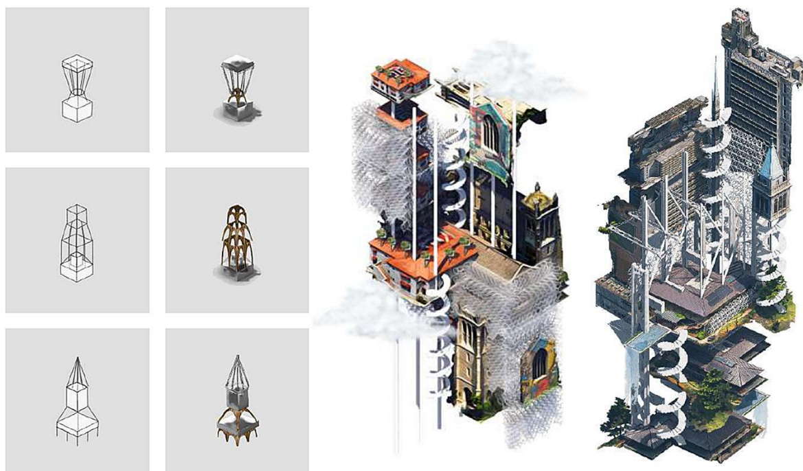
Rys. 15. System Sketch2Pix opracowany przez Kyle'a Steinfelda służący do przetwarzania linearnych szkiców aksonometrycznych na ich fotorealistyczne wizualizacje. Po lewej przykłady prostych modułów zwizualizowanych przez algorytm, po prawej dwa przykłady kolaży stworzonych przez studentów architektury korzystających z algorytmu Sketch2Pix w trakcie zajęć projektowych (Steinfeld, 2020).
