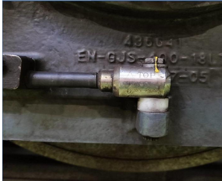
Rys. 8.7 Czujnik przyspieszeń zastosowany umieszczony pod maźnicą wózka. źródło: [14]
