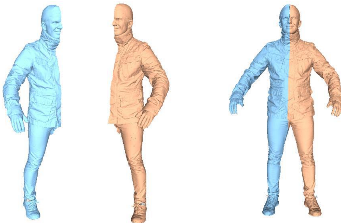
Rysunek 2.11 Przykład orientacji wzajemnej dwóch częściowych chmur punktów (źródło rysunku: [179]).
