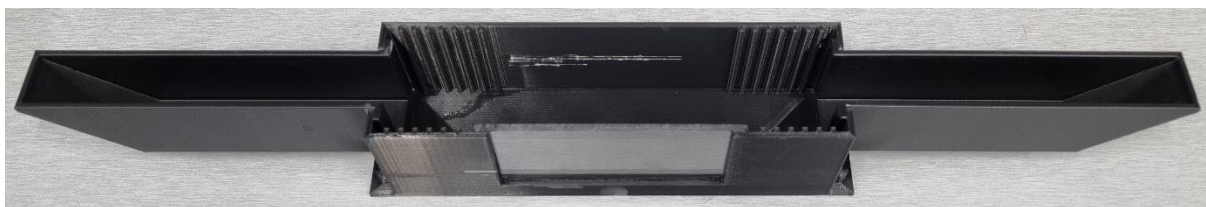
Rysunek 7.26. Zdjęcie zbiornika przygotowanego do pomiarów PIV wewnątrz geometrii wydrukowanych w technologii 3D z wykorzystaniem biokompatybilnej żywicy światło utwardzalnej
