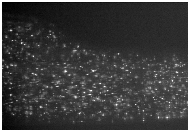
Rysunek 7.6. Zdjęcie pomiarowe PIV w modelu wydrukowanym w technologii 3D z nałożoną powłoką lakierową blokującą promieniowanie UV. Zdjęcie z ekspozycji p_2 wg rysunku 7.7a
