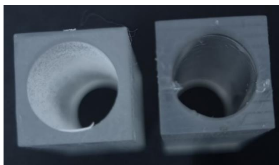
Rysunek 6.13. Porównanie poprawy jakości wizualnej ścianki wewnętrznej drukowanej geometrii przy nałożeniu warstwy polimeru PDMS (b) ze ścianką bez modyfikacji (a)
