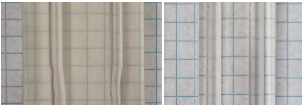
Rysunek 6.3 Zjawisko żółknięcia wydruku pod wpływem promieni UV. Po lewej blok po naświetlaniu powyżej 30 minut, po prawej blok naświetlany przez 10 minut.
