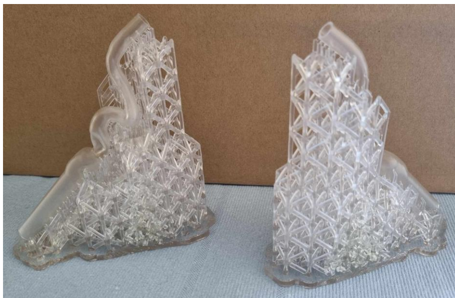
Rysunek 8.1. Obraz wydruku geometrii elastycznej wraz z podporami
