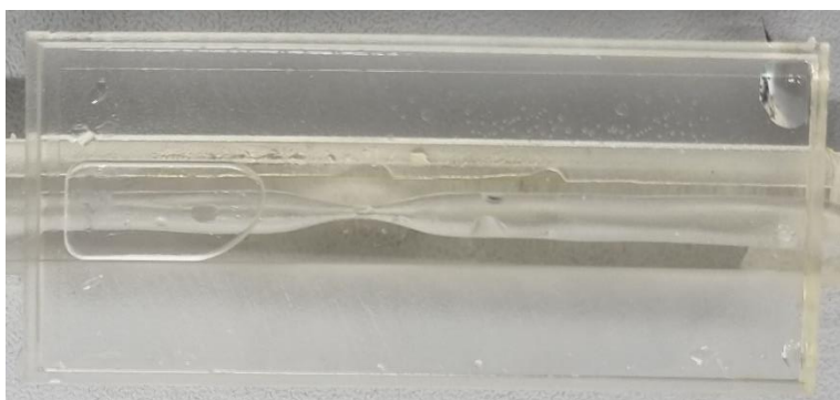
Rysunek 7.48. Model druku 3D przygotowany do pomiarów PLIF
