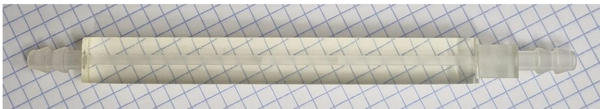
Rysunek 7.12. Wydrukowana geometria modelu tętnicy ze zmianą miażdżycową przygotowana do pomiarów PIV
