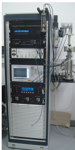
Rysunek 3.2: Analizator impedancji Novocontrol Alpha-A wraz z układem stabilizacji temperatury i głowicą do pomiarów przenikalności elektrycznej. Układ na wyposażeniu Instytutu Wysokich Ciśnień PAN.
