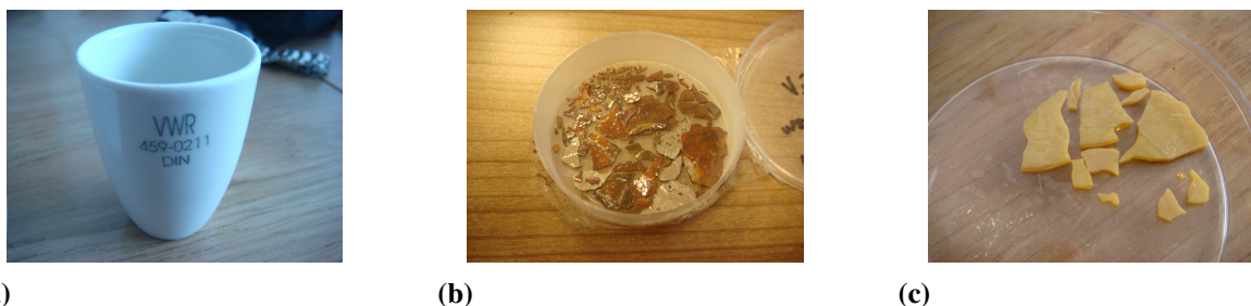
Rysunek 5.1: a) Ceramiczny tygiel wykorzystywany w czasie wytopu próbek \text{Bi}_2\text{O}_3 , b) próbka szklistego \text{Bi}_2\text{O}_3 (z widocznymi napyłonymi platynowymi elektrodami na niektórych odłamkach), c) oraz nanokrystalicznego \delta\text{-Bi}_2\text{O}_3 .
