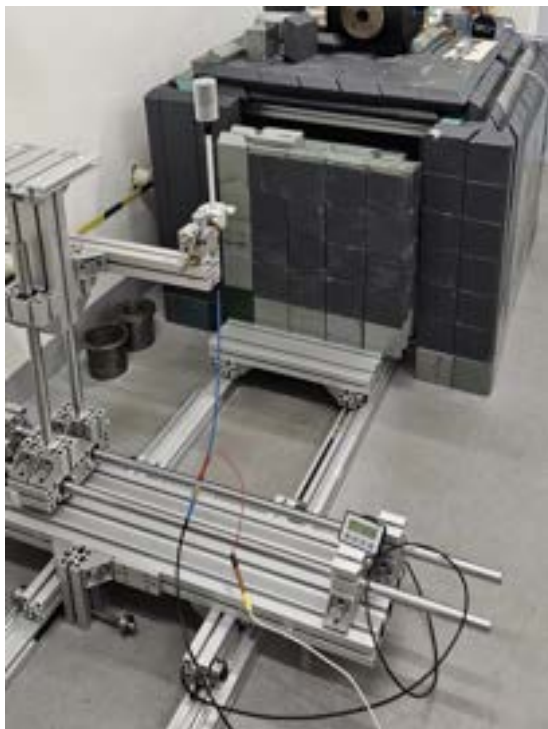
(a) Komora cylindryczna typu 23361 na stanowisku pomiarowym – ława pomiarowa wyposażona została w cyfrowy odległościomierz.
