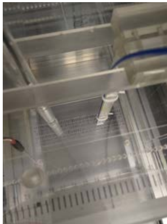
(b) Holder h2 w fantomie wodnym podczas pomiarów w GUM. W komory zastosowano inny element utrzymujący pozycję wodoszczelnej osłonki – standardowo stosowaną w fantomie wodnym GUM płytkę pozwalającą umieścić osłonkę zgodnie w pozycji odpowiadającej perforacjom na dnie i pokrywie fantomu. Element z aplikatorem miał nadal swobodę ruchu od i do komory.
