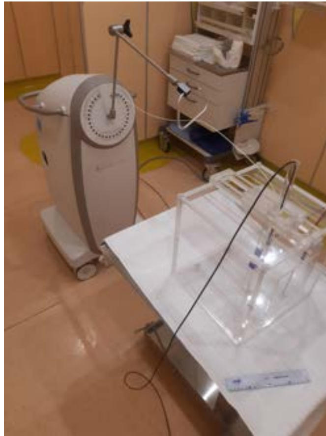
Rysunek 3.21: Układ pomiarowy w ŚCO – fantom z komorą GUM Dw#2 i holderem do źródła (przed napełnieniem wodą) oraz aparat HDR Bravos.
