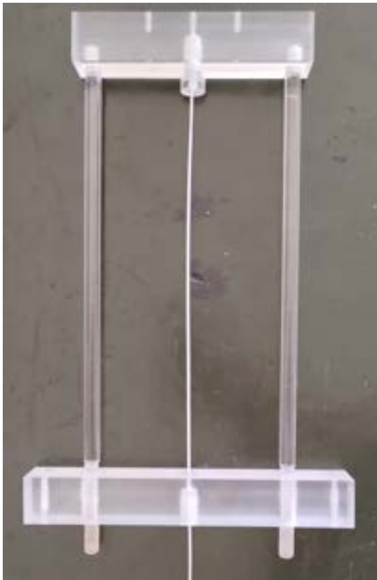
(a) Pierwsza wersja holdera ( h1 ) do aplikatora HDR zbudowana do pomiarów w ŚCO na aparacie HDR Varian Bravos™.
