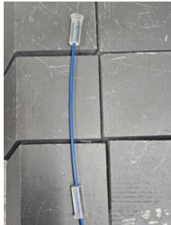
(b) Aplikator LAA1400-GYN z elementami wykonanymi z PMMA umożliwiającymi jednoznaczne pozycjonowanie źródła w osłonie kolimatora.
