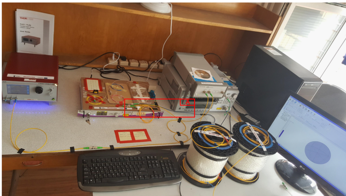
Rys. 5.5 Fotografia układu umożliwiającego wyznaczenie oraz weryfikację stanu polaryzacji fali pompującej na wejściu światłowodu. A - wyjście układu źródła fali pompującej podłączone bezpośrednio do analizatora polaryzacji.
