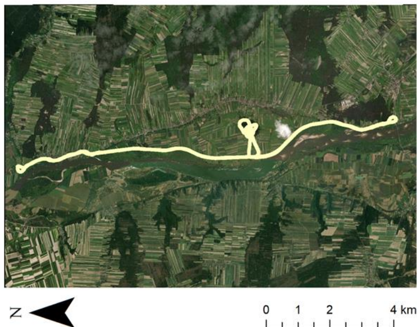
Rysunek 14. Trajektoria bezzałogowego statku powietrznego NEO wyposażonego w skaner ULS z dnia 17.03.2020 r. wzdłuż Wisły od Józefowa nad Wisłą do Annapola
