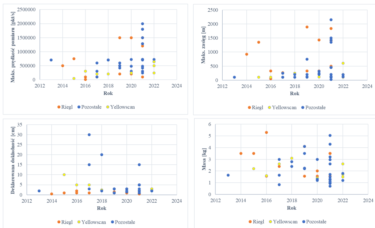
Rysunek 12. Zależności częstotliwości, zasięgu czy dokładności skanowania względem czasu udostępnienia modelu na rynku z wyszczególnieniem firm Riegl i Yellowscan (źródło: zestawienie własne).
