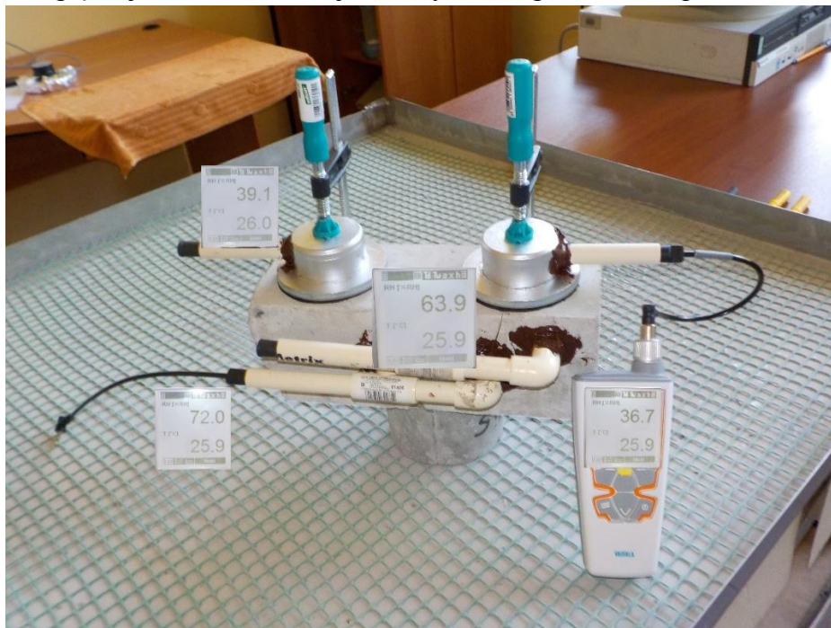
Rys. 1. Pomiar wilgotności powierzchniowej betonu
