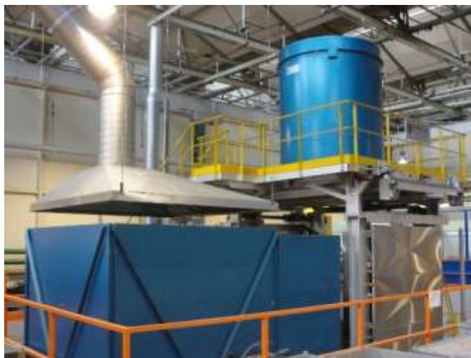
Rysunek 7-3 Piec próżniowy służący do wytwarzania powłoki aluminidkowej w procesie VPA w Avio Polska w Bielsku Białej.
