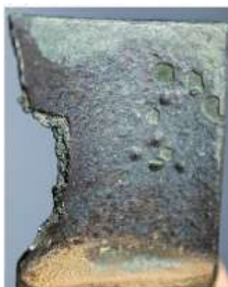
Rysunek 3-59 a) widok skorodowanej łopatki turbiny przemysłowej b) Korozja siarkowa wymaga okresu inkubacji po którym następuje gwałtowna czasem katastrofalna degradacja materiału. (68) (66)
