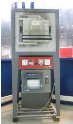
Rysunek 7-4 Piec Mab FE-37 wykorzystany do testu utleniania.
