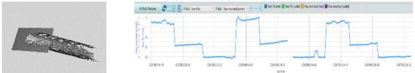
Rysunek 7-10 Przykład skanu wykonanego otworu oraz pomiary dla kolejnych pól.
