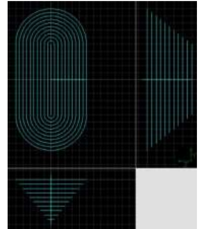
Rysunek 3-26 Wykonanie otworów kształtowych elektrodą kształtową oraz techniką wierszowania elektrodą rotującą.
