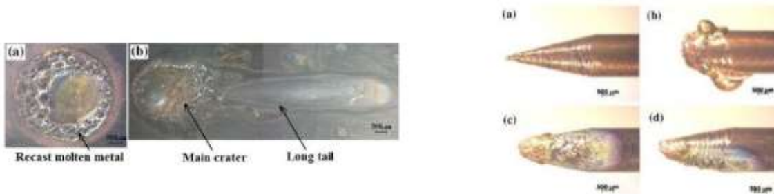
Rysunek 3-38 Deformacja krateru oraz elektrody w wyniku oczyszczania obszaru roboczego sprężonym powietrzem. (36)
