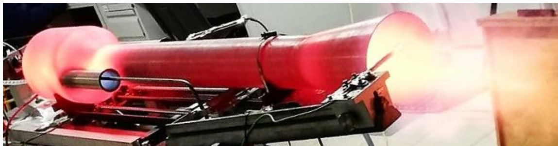
Rys. 4.24. Intensywne nagrzanie silnika zasilanego przez wtryskiwacz 2 mm na głębokości L = 235 mm
