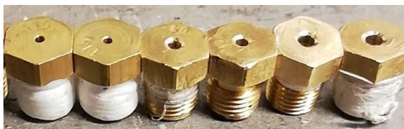
Rys. 4.20. Wtryskiwacze strumieniowe wykorzystywane w pierwszym etapie badań
