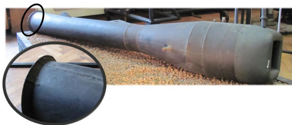
Rys. 2.14. Szczegóły zakończenia przewodu wylotowego silnika SP-3
