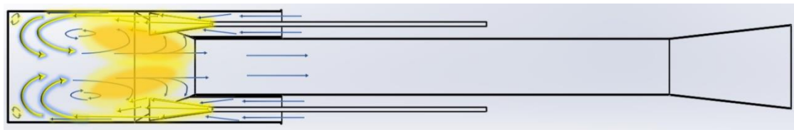
Rys. 4.31. Orientacyjne umiejscowienie strefy spalania silnika zasilanego przez wtryskiwacz JET3, gdy L = 125 \text{ mm}
