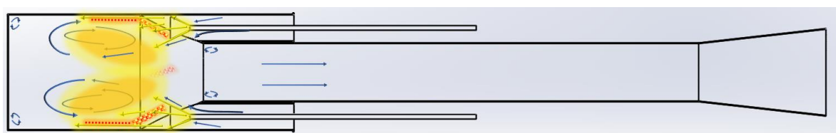
Rys. 4.47. Orientacyjne umiejscowienie stref spalania silnika zasilanego przez wtryskiwacz FC70 – 1 gdy L = 180 mm
