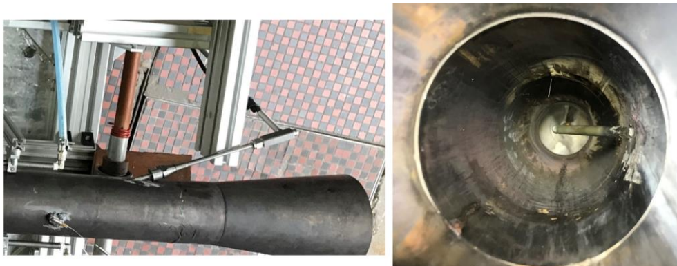
Rys. 6.1. Szczegóły mocowania sondy poboru spalin
