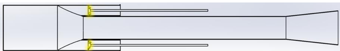
Rys. 4.32. Rozpylenie paliwa przez wtryskiwacz FC120 – 2 umieszczony na L = 125 mm
