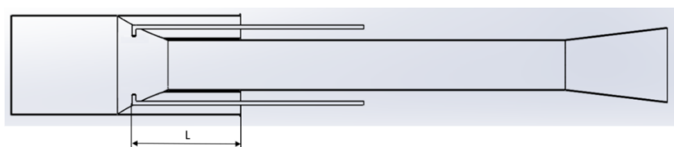
Rys. 4.16. Ustawienie wtryskiwaczy pod kątem 90° do osi podłużnej wlotu powietrza do silnika oraz definicja parametru „L ”
