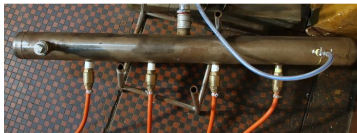
Rys. 4.13. Widok naczynia wyrównawczego z zaworami jednokierunkowymi
