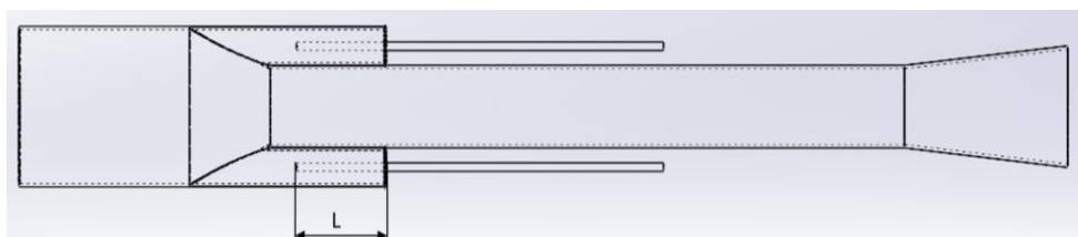
Rys. 4.15. Interpretacja parametru "L" dla ustawienia wtryskiwaczy wzdłuż osi podłużnej wlotów
