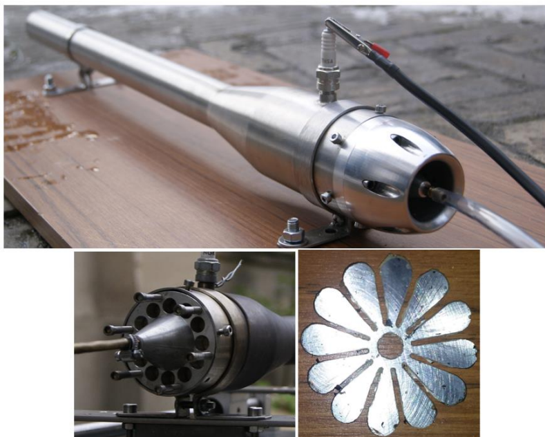
Rys. 2.2. Silnik zaworowy "MelProp" oraz szczegóły budowy zaworów typu płatkowego
