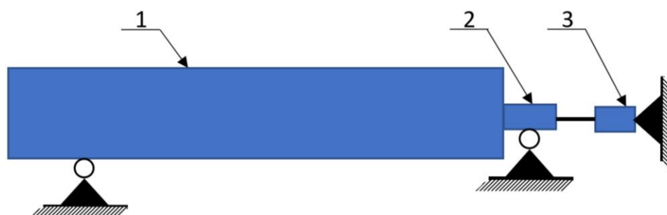
Rys. 4.3. Schemat kinematyczny stanowiska. 1 - silnik, 2 - element przenoszący siłę ciągu, 3 - przetwornik siły
