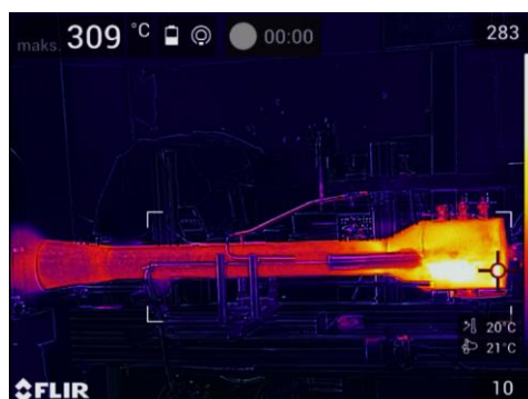
Rys. 4.37. Termogram badanej komory zasilanej przez wtryskiwacze FC120 – 2, L = 180 mm
