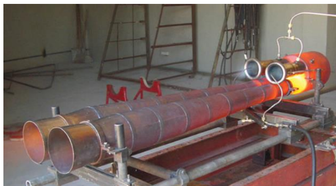
Rys. 2.4. Przykład nowoczesnego pulsacyjnego silnika bezzaworowego do napędu bezzałogowego statku powietrznego [76]
