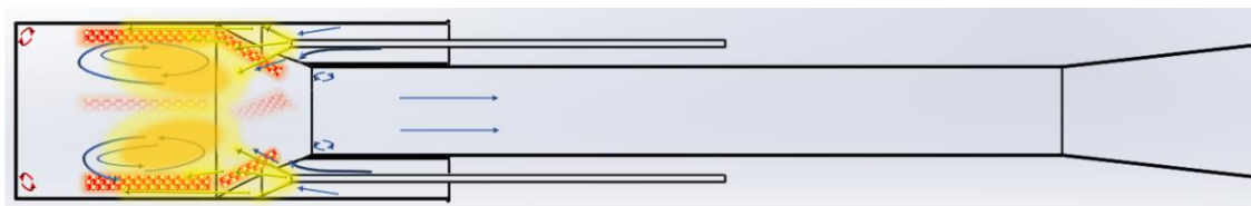
Rys. 4.54. Orientacyjne umiejscowienie stref spalania silnika zasilanego przez wtryskiwacz FC70 – 2, gdy L = 180 mm
