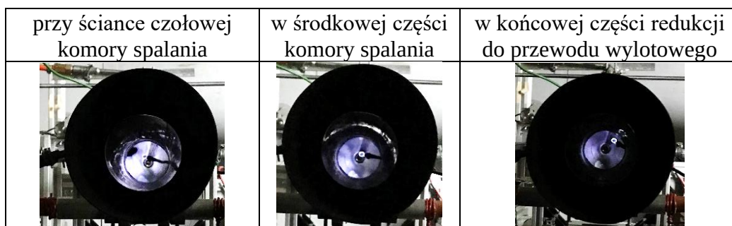
Rys. 4.49. Propagacja światła w przewodzie wylotowym w zależności od umiejscowienia jego źródła
