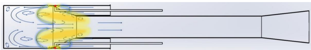
Rys. 4.70. Graficzna ilustracja procesu napełniania i kształtowania stref spalania silnika zasilanego przez wtryskiwacze wirowe FC120 skierowane w stronę ścianki komory spalania
