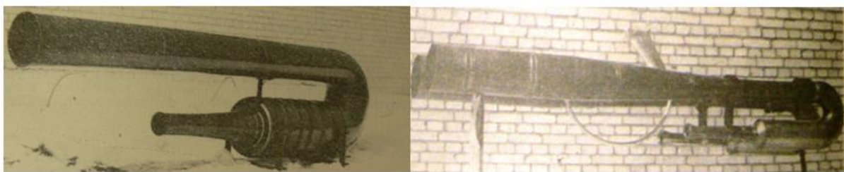
Rys. 2.3. Bezzaworowe silniki pulsacyjne opracowane w Polsce w latach 60 [20]
