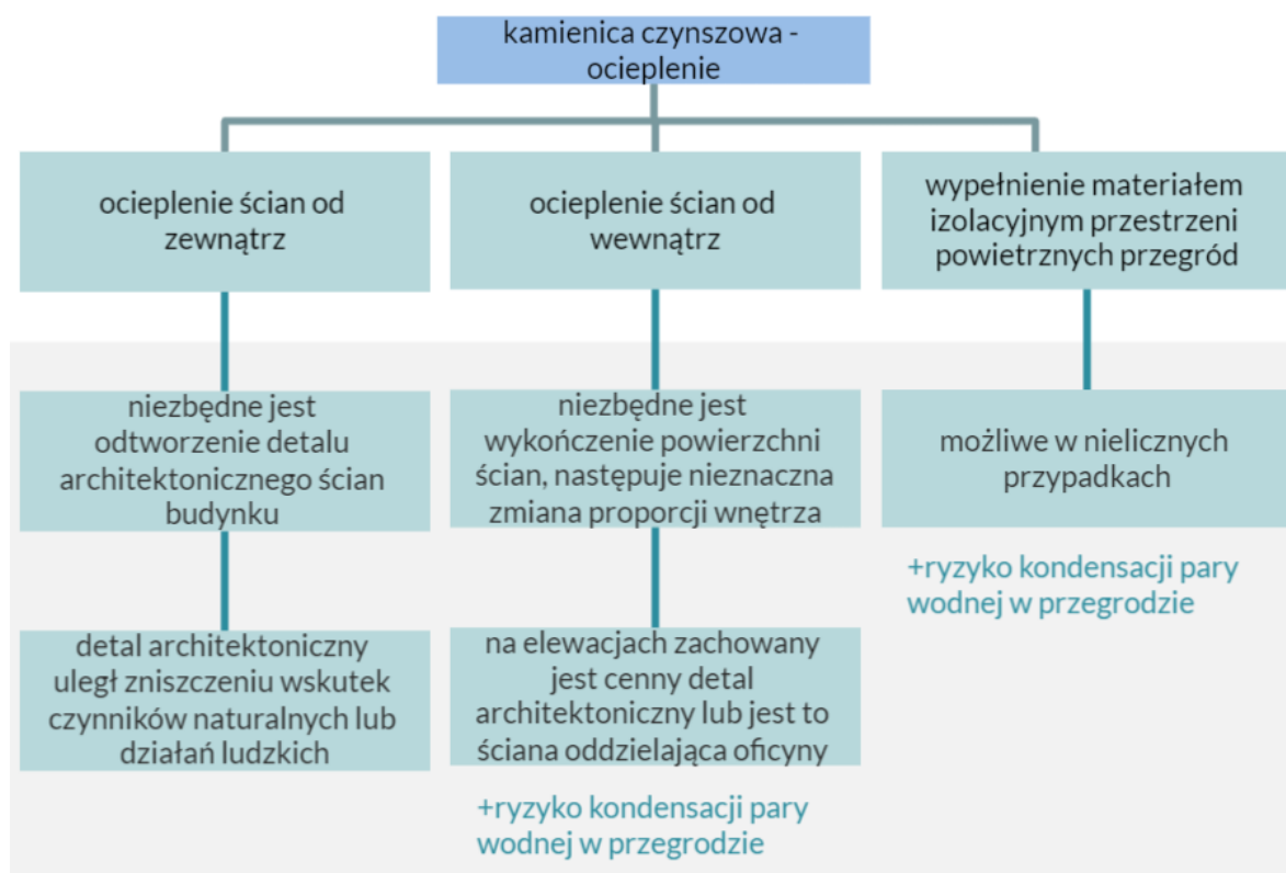
Rysunek 96. Warianty ocieplenia ścian zewnętrznych
