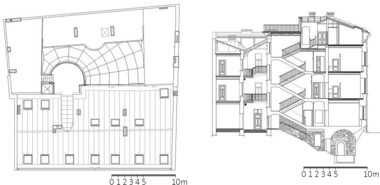
Rysunek 81. Krakowski hotel Copernicus – rzut parteru i przekrój pionowy – stan projektowany.
