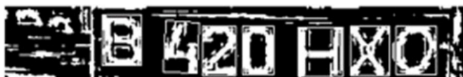
Rysunek 14: Przykładowy rezultat preprocessingu tablicy rejestracyjnej z wykorzystaniem jedynie filtru Gaussa, a następnie binaryzacji Otsu
